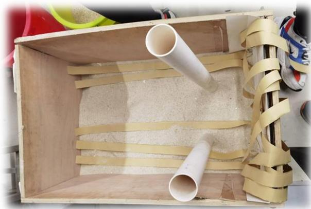
图：将“筋条”一层一层铺在沙中。
